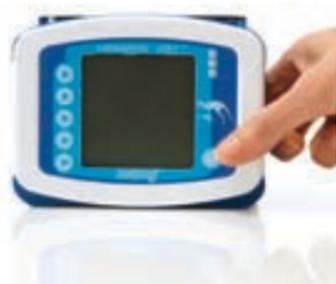
1. Repérer le bouton de démarrage/ arrêt au bas de l'angle droit du panneau de contrôle. Appuyer pour mettre en marche.
