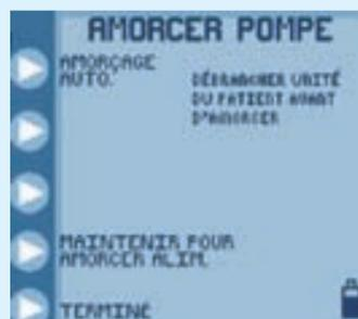
1. Appuyer sur AMORCER puis sur Amorçage automatique pour purger automatiquement ou TENIR appuyé le bouton de purge manuelle pour purger la tubulure. Appuyer sur TERMINE quand la tubulure est purgée.
