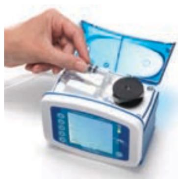
5. Tenir la bague noire, et étendre doucement le tube de silicone pour l'enrouler autour du rotor dans le sens antihoraire. Tracter la bague noire pour la placer dans l'emplacement à droite.
